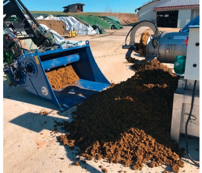
PSS 5.5-550 produziert Feststoffe mit über 30% TS-Gehalt für Einstreu. PSS 5.5-550 produces solids with more than 30% dry matter content as bedding material.
