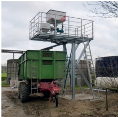
Dieser PSS 2.2-400 mit Vorlagebehälter steht auf einem Schweinemastbetrieb mit ca. 5% TS in der Ausgangsgülle. Der Kipphanhänger ist nach ca. 1,5 Tagen mit dem Separationsmaterial gefüllt. This PSS 2.2-400 with hopper runs on a pig production farm with a dry matter content of about 5% in the raw material. The tipping trailer is filled within 1,5 days.
