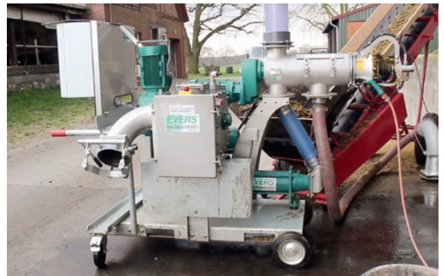
ComPress mit integriertem Schneidfilter zum Schutz der Pump- und Anlagentechnik produziert Einstreu für den Kuhbetrieb. | ComPress with integrated cutting system to protect pump and other technology produces organic bedding material for cow farming.
