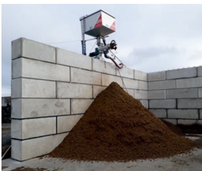
Rohgülle von ca. 6,5 % TS wird auf ca. 20 % TS Gehalt abgepresst und schafft ca. 7 m 3 pro Stunde. Raw material with 6,5 % dry matter is pressed to 20 % dry matter and reaches a throughput of 7 m 3 .
