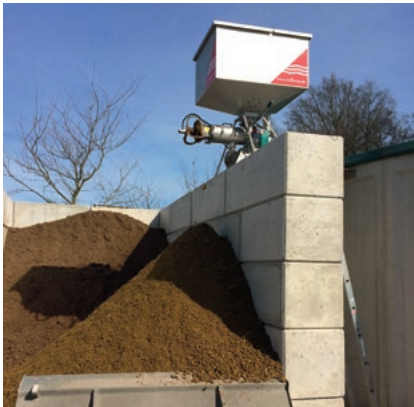
Rohgülle von ca. 6,5 % TS wird auf ca. 20 % TS Gehalt abgepresst und schafft ca. 7 m 3 pro Stunde. Raw material with 6,5 % dry matter is pressed to 20 % dry matter and reaches a throughput of 7 m 3 .
