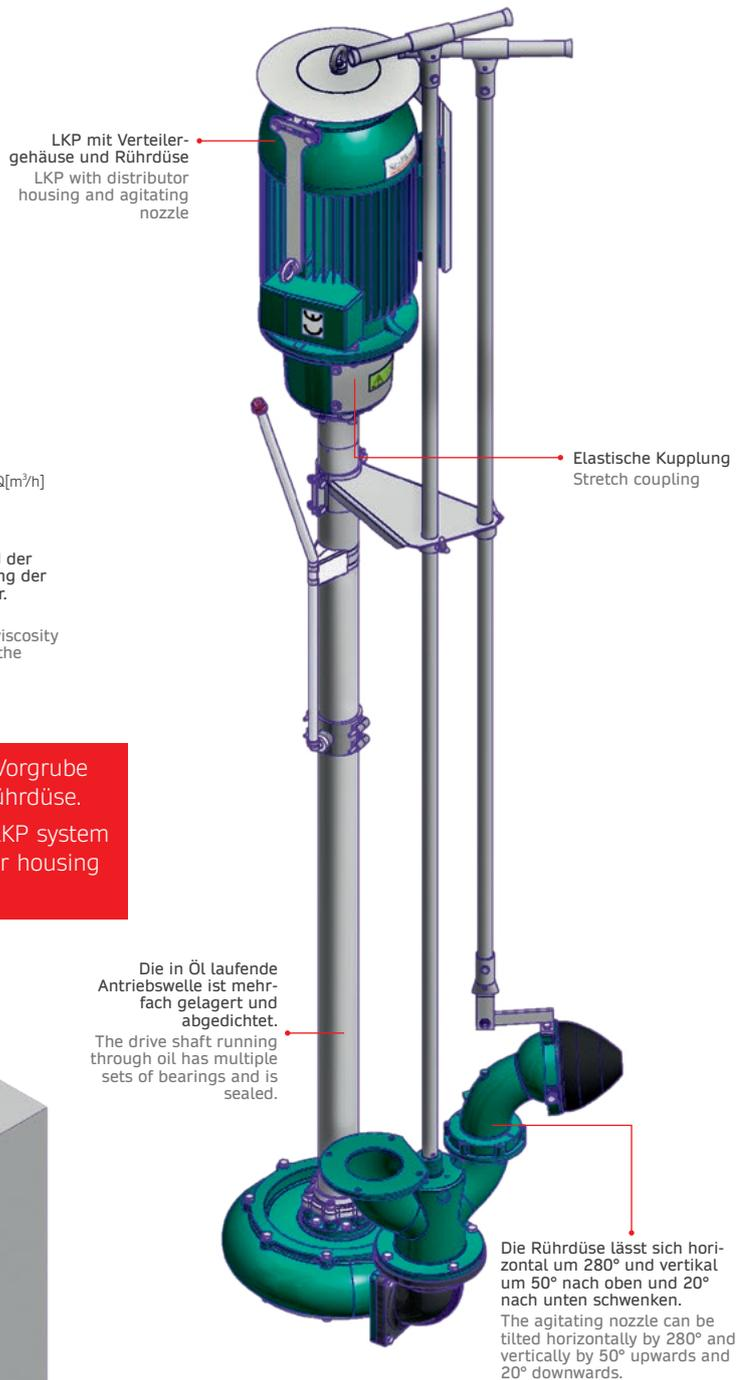
LKP mit Verteilergehäuse und Rührdüse
