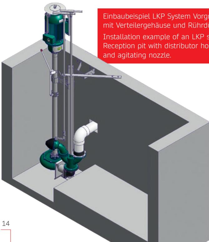
Einbaubeispiel LKP System Vorgrube mit Verteilergehäuse und Rührdüse.
