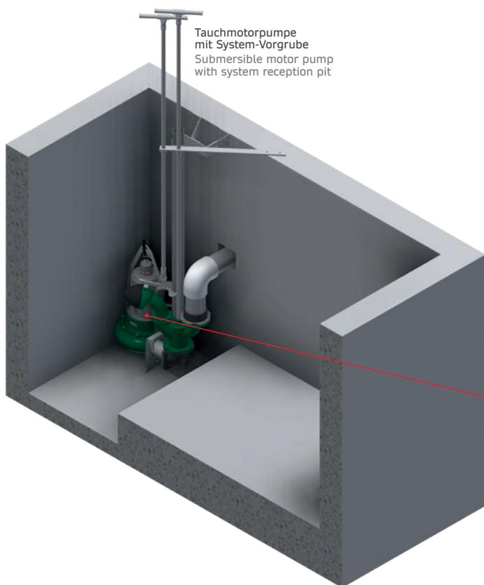
Tauchmotorpumpe mit System-Vorgrube
