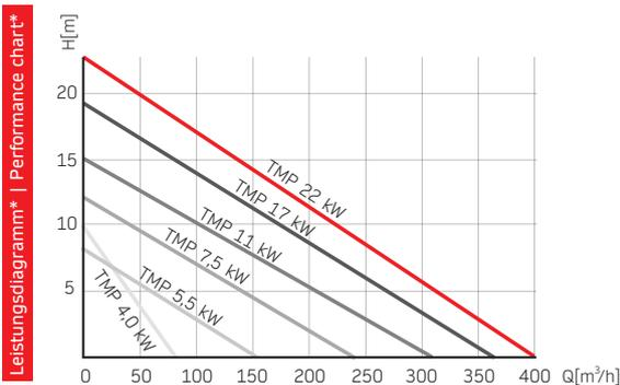
\*Prüfstand mit Wasser | Test bed with water
